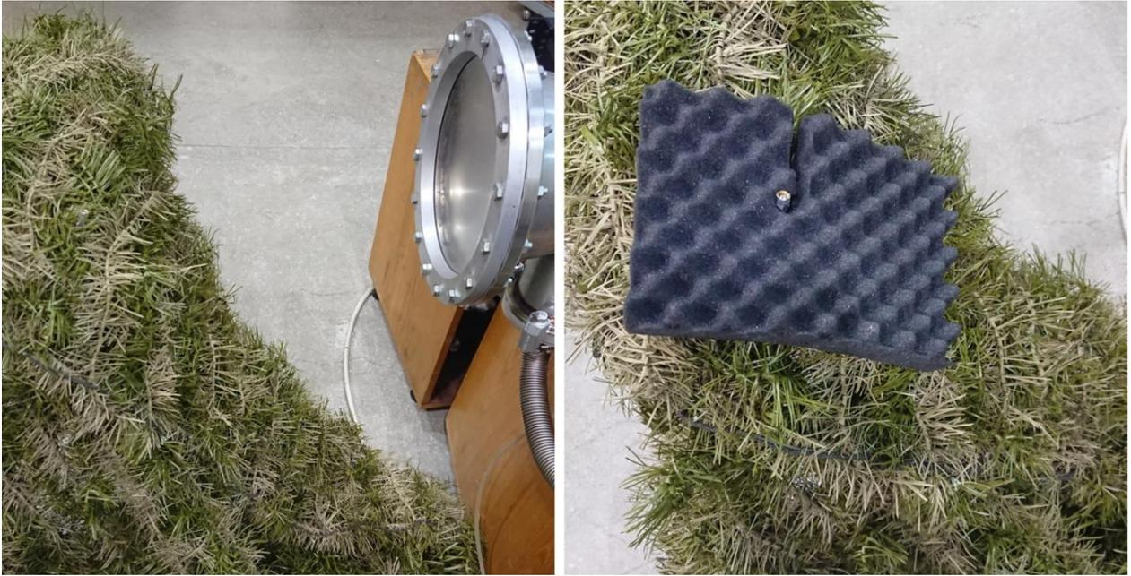
Рис. 3.6. Выходной рупор плазменного лазера (слева) и измерительная антенна, окруженная СВЧ-поглотителем (справа).
