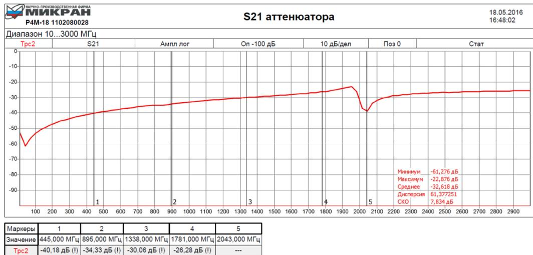
Рисунок 2.4. Коэффициент передачи от входа к выходу аттенюатора.
