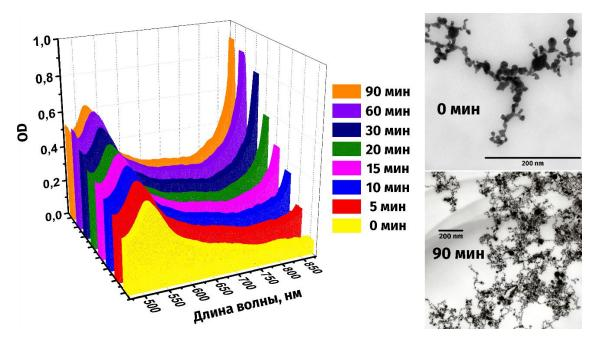
Рис.2. Эволюция спектров экстинкции (слева) и морфологии (справа) коллоидного раствора композитных НЧ золота при длительном нахождении в магнитном поле напряженностью 7 Тл.
