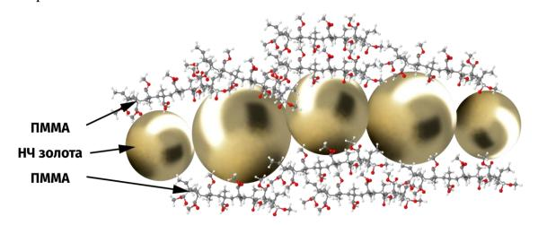
Рис. 5. Схема объединения золотых наночастиц в удлиненные цепочки в полимерной матрице ПММА при синтезе полимерного нанокомпозита Au-ПММА.
