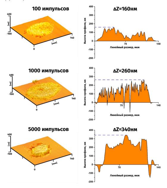
Рис.7. АСМ-изображения углеродных нанокомпозитов, осажденных при разном количестве поглощенных лазерных импульсов: 100 имп/точку, 1000 имп/точку и 5000 имп/точку. Источник лазерного излучения – иттербиевый волоконный лазер, длина волны генерации 160-1070 нм, длительность импульса - 100 нс, частота повторения – 20 кГц плотность энергии – 7 Дж/см².
