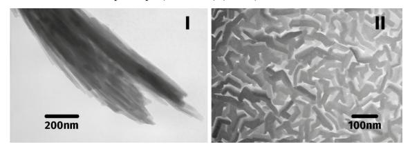
Рис.3. ПЭМ изображения наночастиц фталоцианина меди на разных стадиях лазерной фрагментации. (1) — начальная стадия; (2) — после 10 минут лазерной фрагментации. Источник излучения — иттербиевый волоконный лазер с длиной волны генерации 1060-1070 нм, частотой повторения 20 кГц, длительностью импульса 100 нс.
