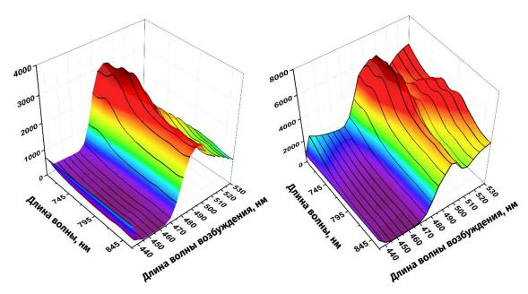
Рис.6. Карты люминесценции НЧ ФЦ алюминия в коллоидном растворе (слева) и в составе полимерного нанокомпозита AlPC-ЛФ32 (справа). Возбуждение осуществлялось в диапазоне 440 – 530 нм с шагом 5 нм.
