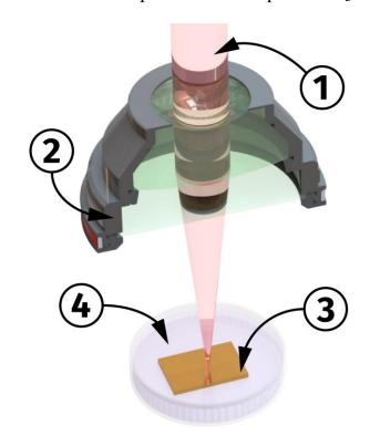
Рис. 1. Схема экспериментальной установки по лазерной абляции в жидкости: 1 – лазерный пучок; 2 – фокусирующая линза (в основном используется F-Theta объектив); 3 – мишень; 4 – кювета с рабочей жидкостью.
