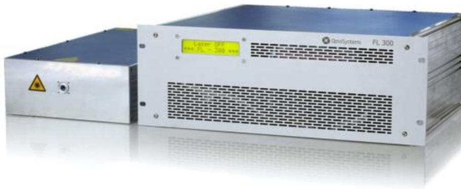
Рис. 15 – Волоконный фемтосекундный лазер FL-300 с характеристиками: длина волны излучения 1035 нм, длительность импульса 250 фс, энергия импульса 3 мкДж, частота повторения импульсов от 100 Гц до 1 МГц, поляризация линейная, вертикальная
