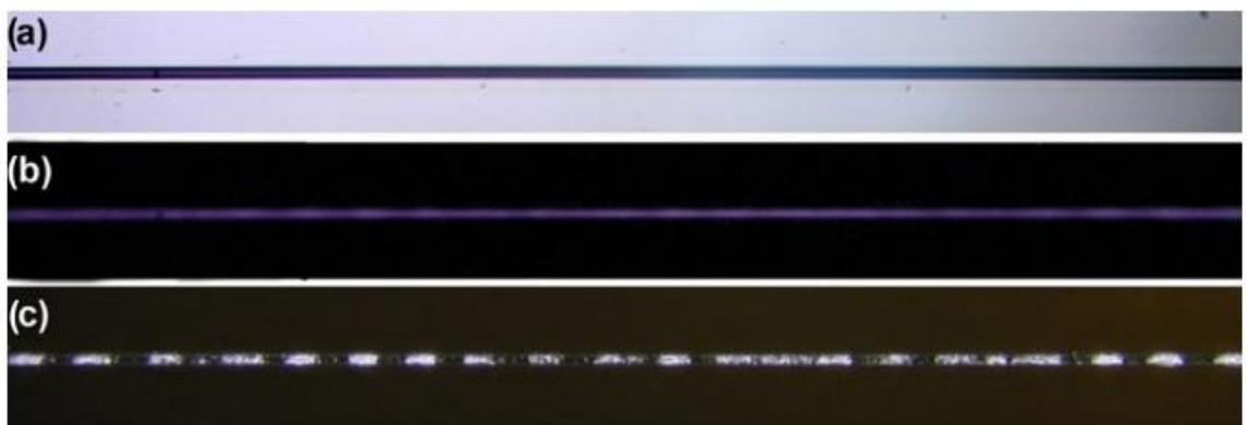
**Рис. 52 Фотографии одного и того же участка световода до (a), во время (b) и после (c) прохождения по нему ОР. Световод без полимерного покрытия был помещён в иммерсионную жидкость. Лазерное излучение распространялось слева направо. Условия подсветки: (a) сзади, (b) только собственное излучение плазмы ОР (излучение лазера отфильтровано), (c) подсветка сбоку. Размер кадра по горизонтали 3,5 мм. [160]**
