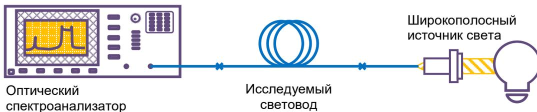
Рисунок 2.1 – Схема измерения спектра поглощения в световоде
