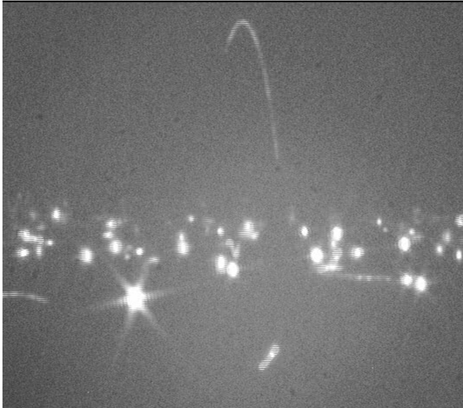
Рис. 6.3. Трек пылевой частицы после воздействия Ar лазера
