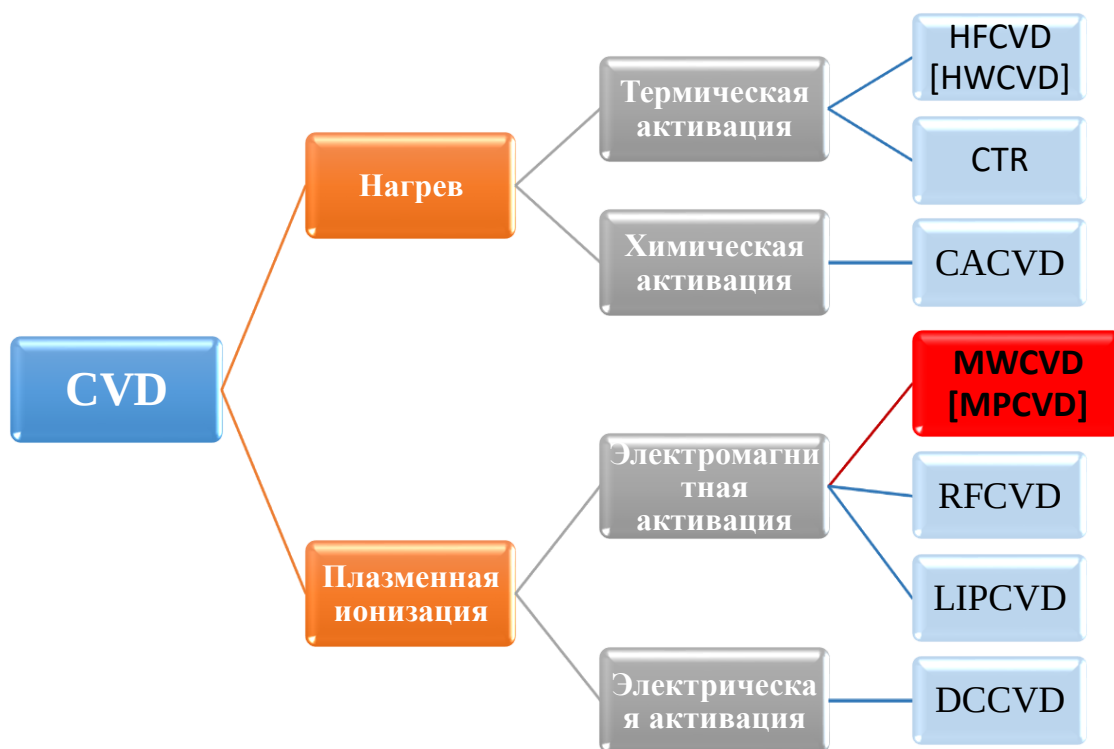
Рис. 8. Методы CVD синтеза алмаза.
