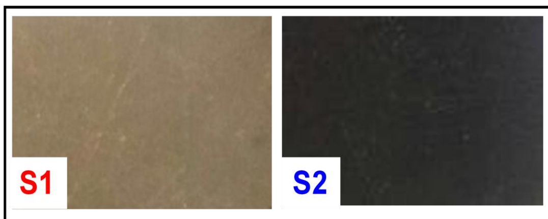
Рисунок 31. Фотографии двух состояний поверхности \text{SmB}_6 , полученные с четырехкратным увеличением. S1 соответствует шлифованной поверхности, S2 – восстановленной посредством травления в азотной кислоте.
