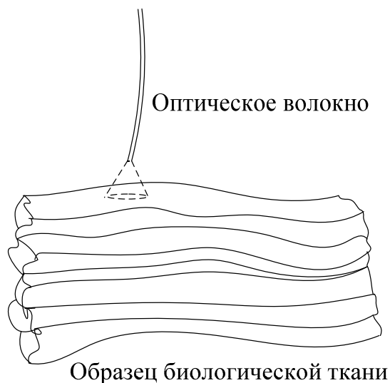
Рис. 73 – Схема бесконтактного метода воздействия лазерного излучения на образец биологической ткани (свиная мышечная ткань).
