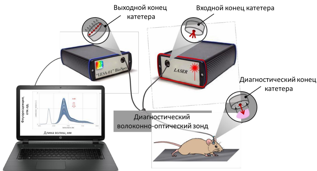
Рисунок 12. Схема экспериментальных исследований работы нейросистемы на лабораторных животных в совокупности с волоконно-оптическим анализатором ЛЭСА-01-БИОСПЕК. (1) Компьютер с программным обеспечением, (2) спектроанализатор, (3) лазерный источник.
