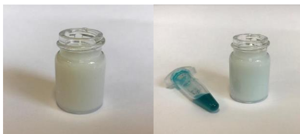
Рисунок 20. а) Фантом мягкой ткани головного мозга (2.5% жировая эмульсия); б) Фантом мягкой ткани головного мозга (2.5% жировая эмульсия) с добавлением молекулярного раствора AlPc.
