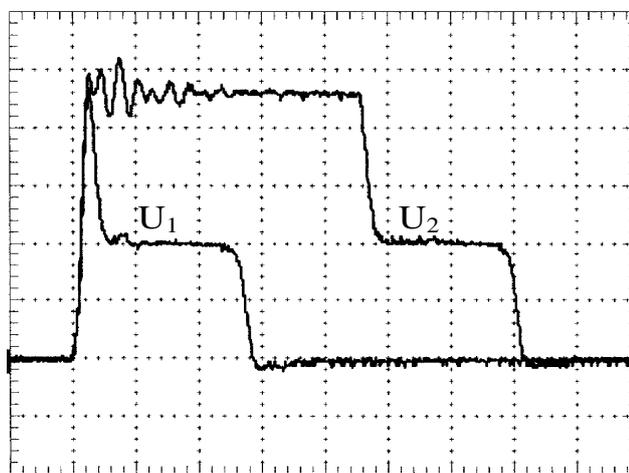
Рис.2.7 Типичные осциллограммы напряжения  $U_1$ ,  $U_2$  на разрядном промежутке (развертка 100 нс/дел.) для двух разрядных импульсов в отсутствие УФ подсветки промежутка, когда на РП разряжался конденсатор.
