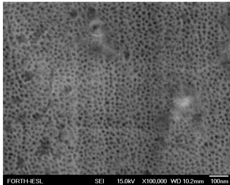
Рис. 9. Морфология поверхности алюминия после его анодного травления в серной кислоте.
