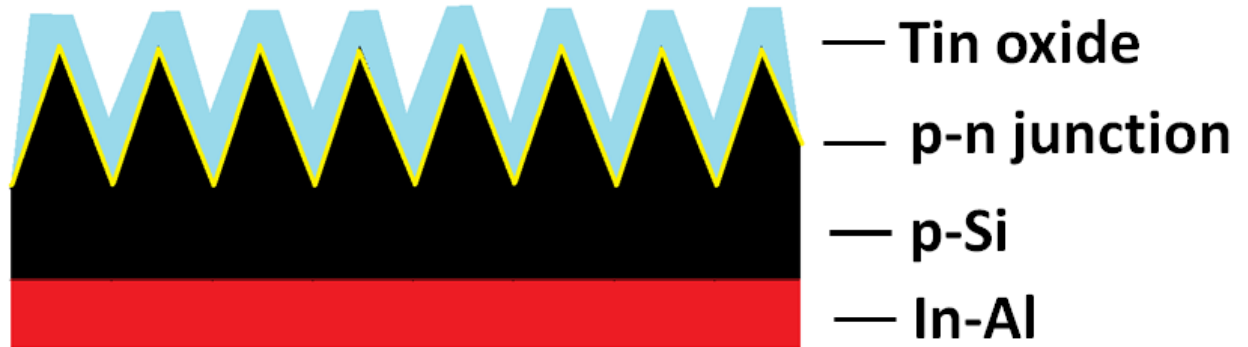
Рис. 1.14. Схема солнечного элемента на основе ЛМК в разрезе.
