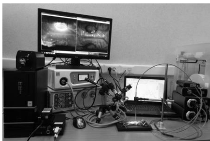
Рисунок 3. (а) Макет приборного комплекса неинвазивной спектроскопической оценки состояния кожного покрова и степени прижизнения трансплантируемых тканей; (б) схема работы системы для видеофлуоресцентного анализа.
