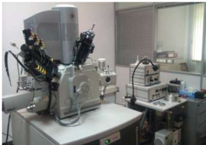
Рисунок 2.7. Фотография электронно-ионного сканирующего микроскопа фирмы Quanta 3D FEG.
