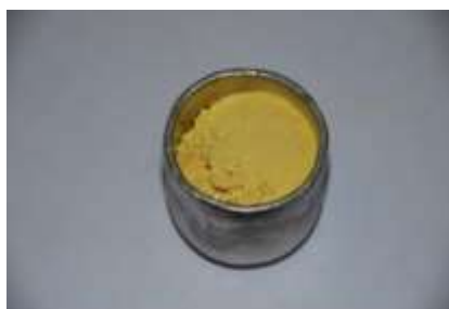
Рисунок 2.2. Тигель размера 40x2x40 с шихтой.
