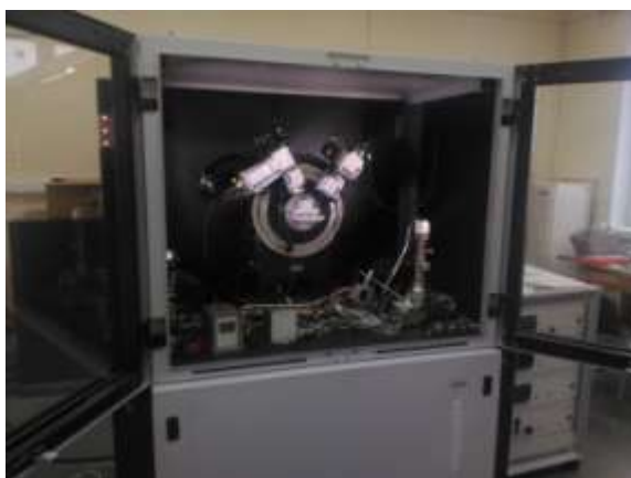
Рисунок 2.6. Фотография рентгеновского дифрактометра Bruker D8 Discover A 25 Da Vinci Design.
