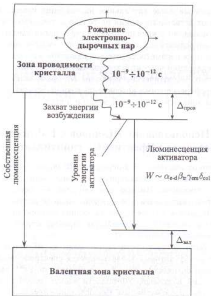
Рисунок 1.33. Схема преобразования энергии в активированном кристалле [65].
