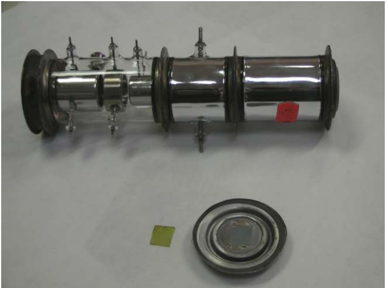
Рисунок 4.10. Фотография электронно-оптического преобразователя типа ПИФ-01 с люминофором в виде эпитаксиальной пленки Pb_{0,02}Ce_{0,05}Gd_{2,93}Al_{4,29}Ga_{0,71}O_{12} .
