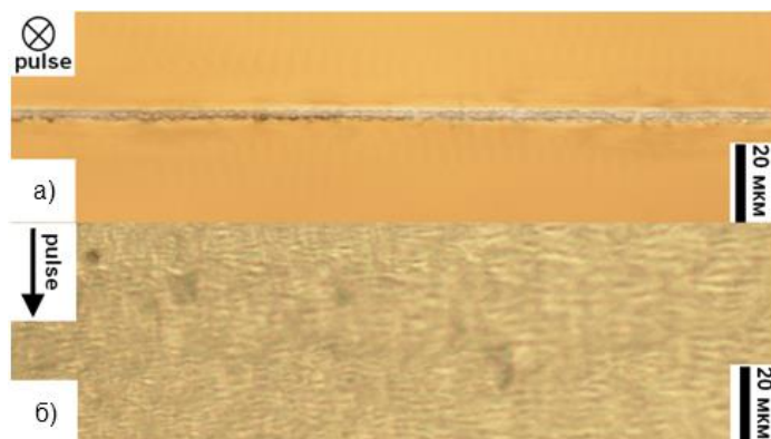
Рис. 7. Микрофотографии реза. E_{и} = 10 мкДж, NA = 0.545 , V_{ск} = 800 мкм/сек, f = 200 Гц, оптическое стекло ВК7, толщина 1,03 мм.
