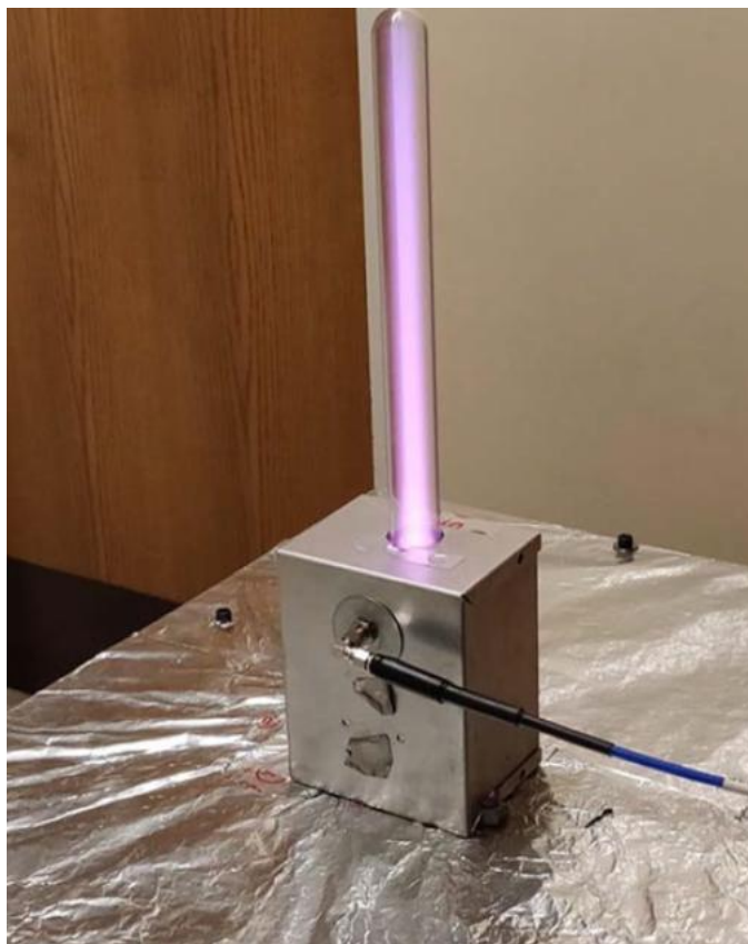
Рисунок 1.2 – Несимметричный вибратор на основе разряда, поддерживаемого поверхностной электромагнитной волной.
