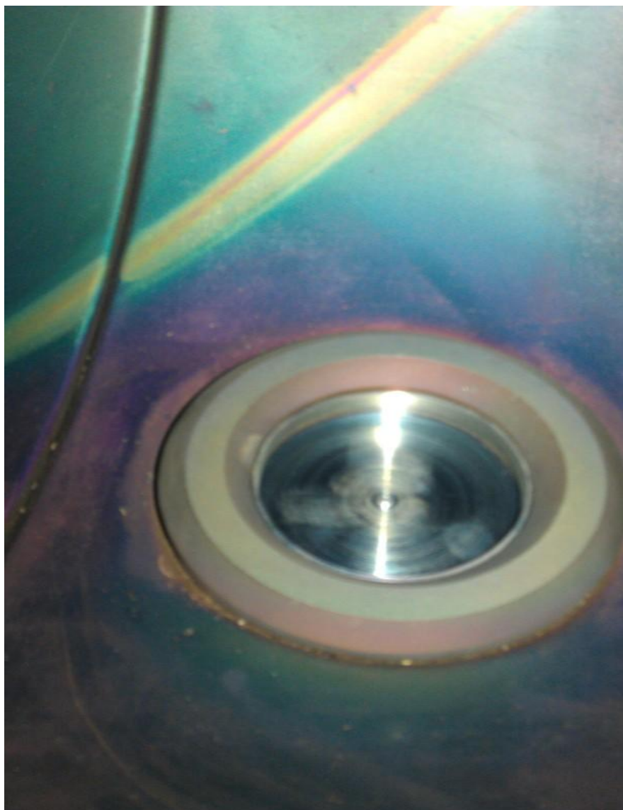
Рис. 106. След спиральной сепаратрисы на стенке вакуумной камеры стелларатора
