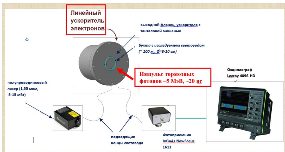
Рисунок 6.1 – Схема экспериментов по измерению РНП после импульсного воздействия на \lambda=1,55 мкм. При измерении на длинах волн \lambda=659 и 828 нм использовался кремниевый фотоприемник, а на \lambda=1310 и 1550 нм – германиевый [274], [290].
