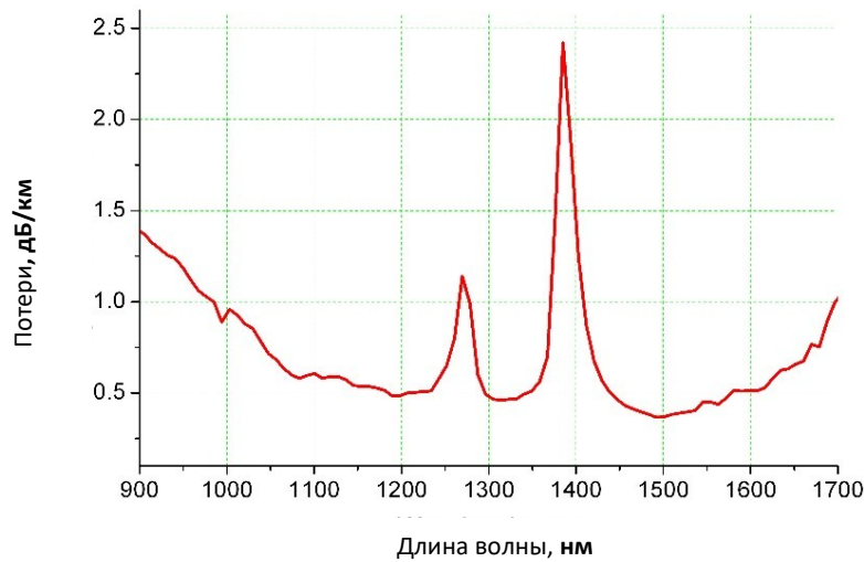
Рисунок 4.3 – Спектр начальных оптических потерь ВС O_2:SiO_2 с большим избытком кислорода в сердцевине ( R=2 ) с длиной волны отсечки \lambda_{cut}=1,47 мкм [207].
