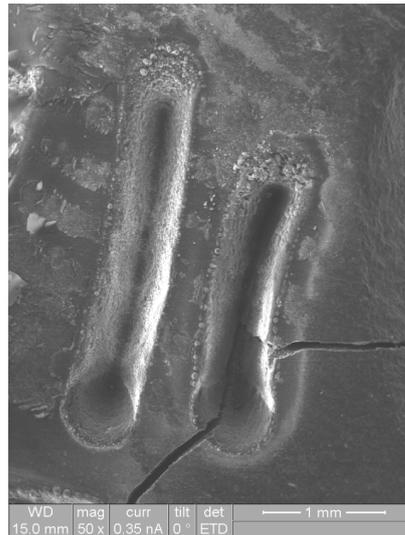
Рисунок 2.2 – РЭМ-изображение области взаимодействия лазерного излучения ( $\lambda = 1,06$  мкм) с поверхностью шунгитовой мишени при изменении скорости  $v$  сканирования: слева –  $v = 400$  мкм/с, справа –  $v = 200$  мкм/с (видно образование трещин). Диаметр лазерного пучка на мишени – 400 мкм, энергия в лазерном импульсе – 1 Дж, частота следования лазерных импульсов – 50 Гц, длительность лазерного импульса – 1 мс.
