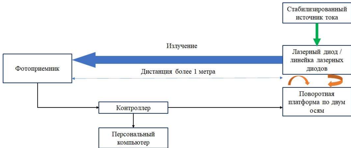
Рисунок 2.29 – Схематическое изображение установки измерения дальнего поля.
