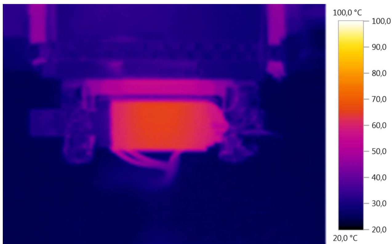
Рисунок 4 – Типичное температурное распределение на брэгговской решётке при выключенном нагревательном элементе. Вид на излучатель сверху.
