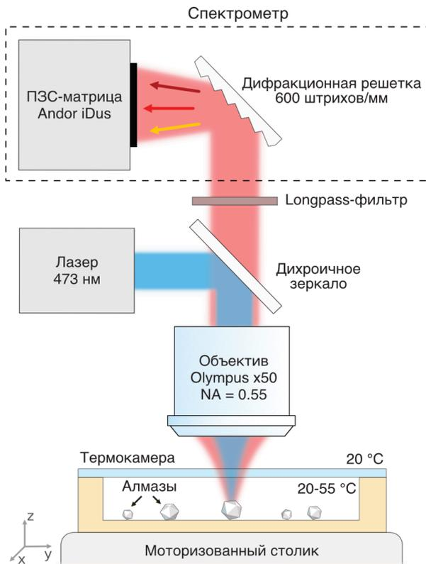
Рисунок 2.1 – Схема экспериментальной установки для измерения температурной чувствительности SiV-центров в алмазных частицах.
