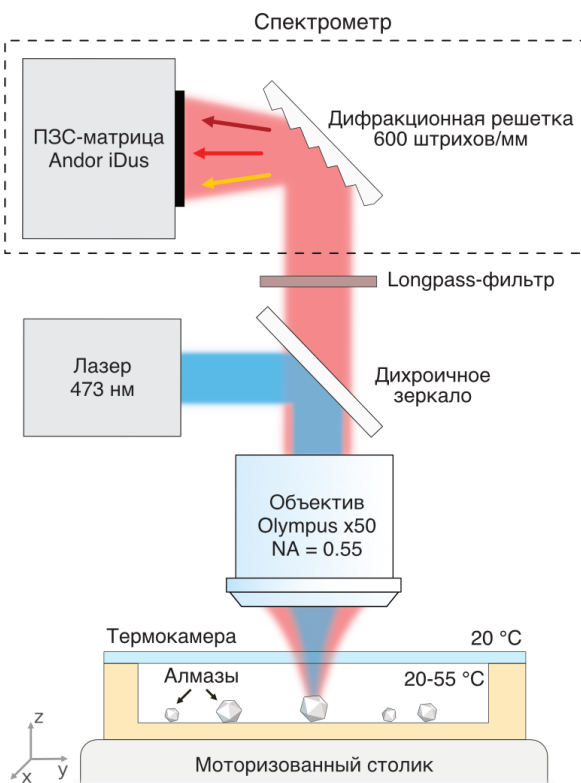
Рисунок 1 – Схема экспериментальной установки для измерения температурной чувствительности SiV-центров в алмазных частицах.
