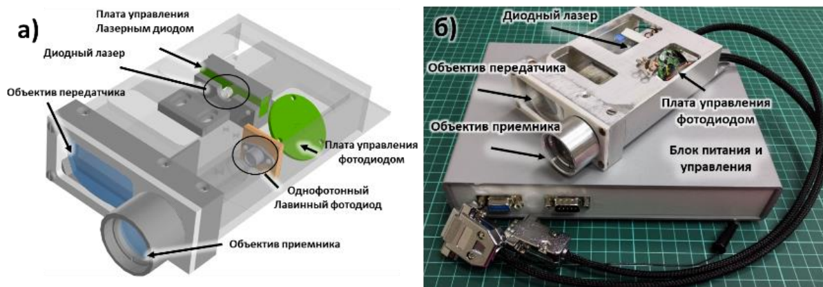
Рисунок 10 Разработанный в ИОФ РАН аэрозольный лидар в статистическом режиме работы. (а) трёхмерная модель оптического блока лидара; (б) фотография лидара в сборе без корпуса
