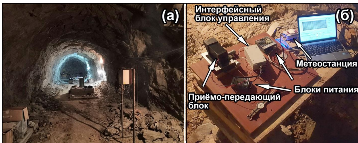
Рисунок 17 Горячий тоннель низкофоновой лаборатории ИФЗ (а) и платформа (б) с лидаром, интерфейсным блоком управления, метеостанцией и управляющим компьютером у правой стены тоннеля
