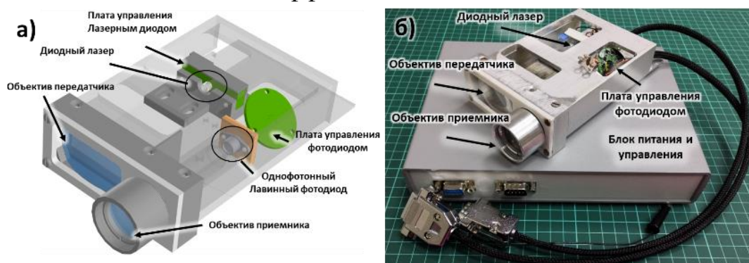
Рис. 4 Разработанный в ИОФ РАН аэрозольный лидар в статистическом режиме работы. (а) трёхмерная модель оптического блока лидара; (б) фотография лидара в сборе без корпуса
