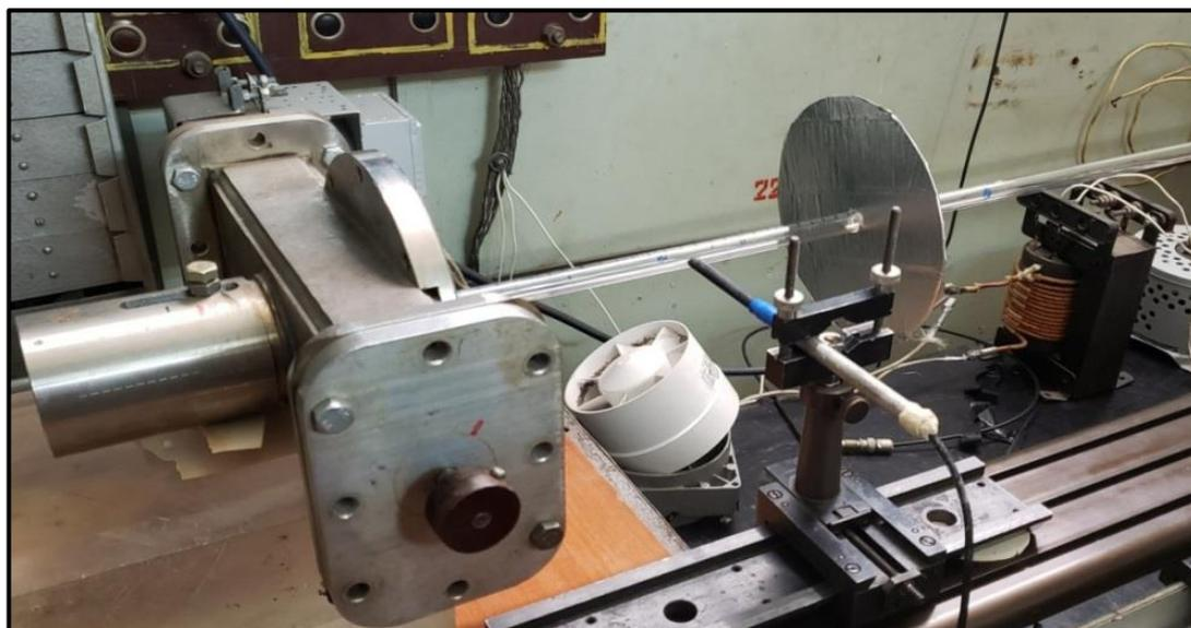
Рисунок 2.7. Фото экспериментального стенда по возбуждению разряда, поддерживаемого стоячей ПЭВ.
