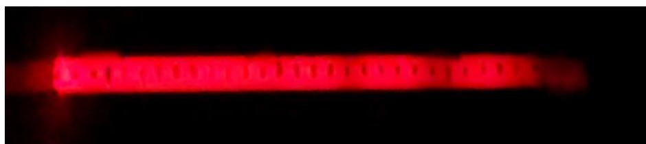
Рисунок 4.12. Фото стационарного разряда, достигшего второго зеркала.
