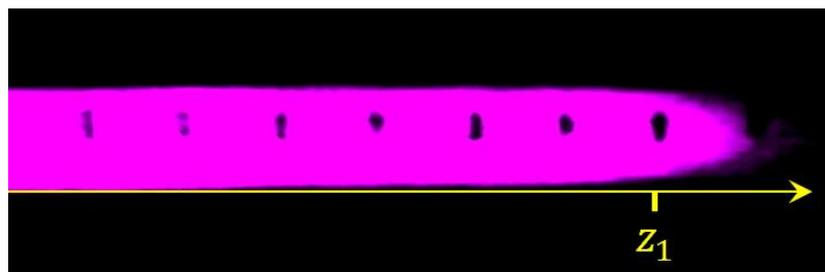
Рисунок 4.5. Фото распространяющегося разряда ( $p = 0.1$  Торр). Расстояние между метками 1 см; расстояние от фронта разряда до аппликатора  $z_1 \approx 50$  см.
