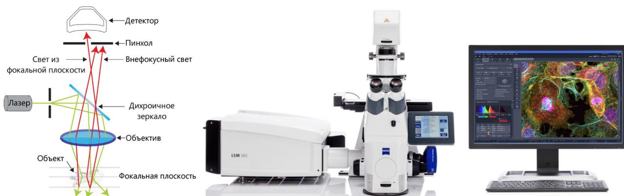
Рисунок 2.10 – Лазерный сканирующий микроскоп Zeiss LSM и оптическая схема работы конфокального микроскопа
